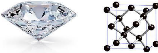
شکل (۸): سلول مکعبی قراردادی شبکه الماسی
